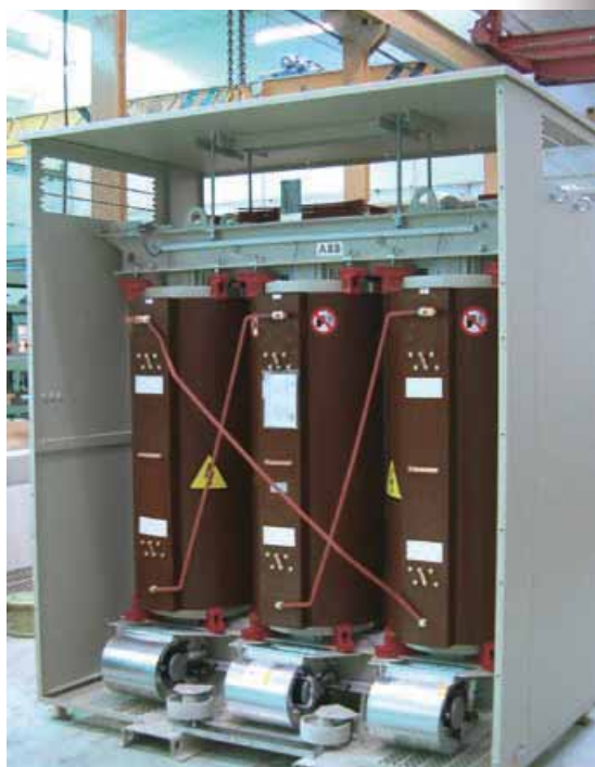
Вентиляторы принудительного охлаждения (AN/AF) для вентиляции каналов охлаждения. Повышение мощности трансформатора до 50%.
