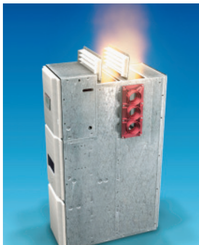
Испытание на устойчивость к электрической дуге
